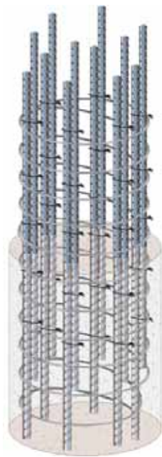
Spojevi preklapanjem otežavaju ugradnju i konsolidaciju betona.
